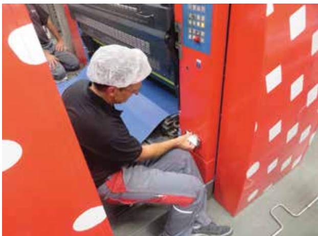
Výměna ofsetového potahu na stroji Rapida 145: potah se pomocí aplikace eviduje na tiskové jednotce, na které se používá, a lze tak přesně sledovat a plánovat jeho dobu použitelnosti.
